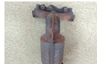
1999年製「ライフ」排気マニホールドの割れ
